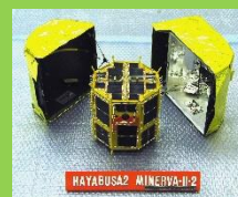
「はやぶさ2」搭載の小惑星探査 ロボットMINERVA-II2
