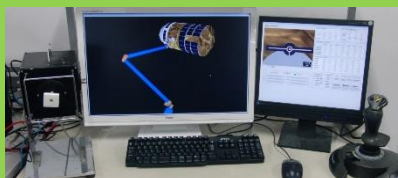
宇宙コンピュータSSRMSによる HTV捕獲の動力学シミュレータ
