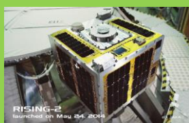
50kg級超小型地球観測衛星 “RISING-2” (運用中)
